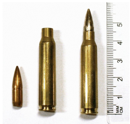
Projektile, Patronenhülse und vollständige Patrone
