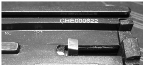
Importmarkierung auf der Schlitten - Unterseite
