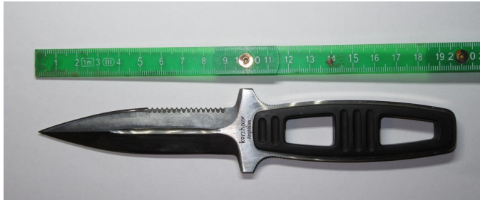
Beispiel für einen symmetrisch geschliffener Dolch
