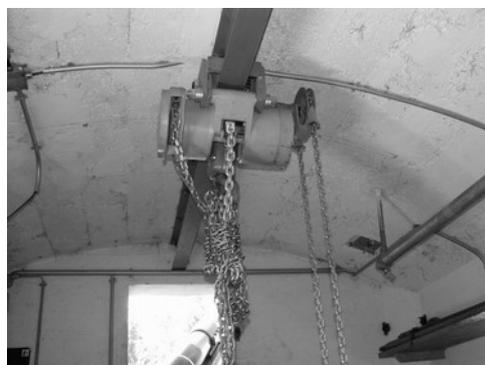
*Abbildung 23: Flaschenzug im Kampfstand (Bild vom Jaunpass)*
