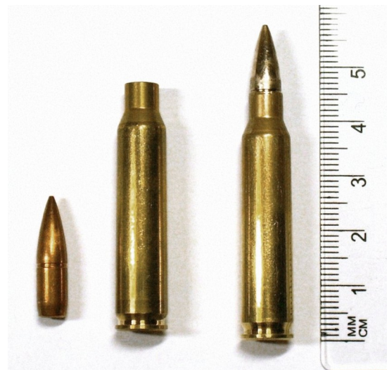
Projektile, Patronenhülse und vollständige Patrone
