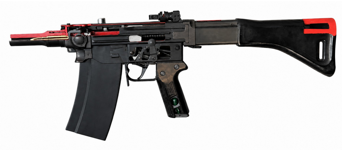
Schnittmodell eines Sturmgewehr 57 (mit freundlicher Genehmigung von swisswaffen.com )
