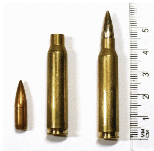
Projektile, Patronenhülse und vollständige Patrone
