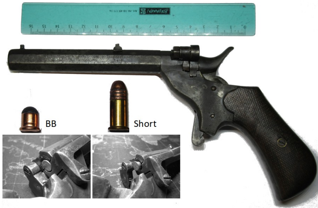
Beispiel eines Kaninchentöters. Es können nur BB geladen werden
